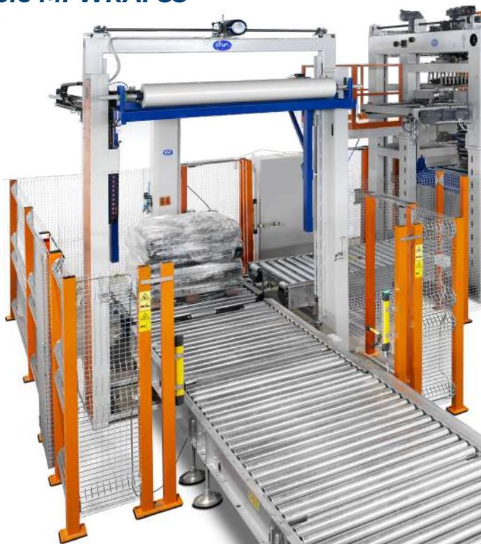
Sulla ralla di rotazione può essere montata una piattaforma a rulli o a catenarie, a seconda delle esigenze di layout e del tipo di pallet.
