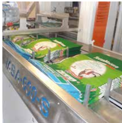
Sackmagazin mit 3 Positionen und Drehsortierer Entrepôt sacs à trois positions avec effeuilleur rotatif
