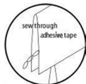
Anbringung von Klebestreifen auf der Naht
