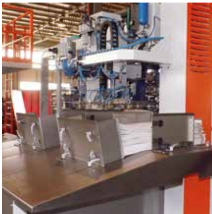
Sackmagazin mit 2 Positionen Entrepôt sacs à deux positions
