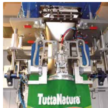
Bouche-sac pour des sacs à soufflet Side gusseted bag filling spout
