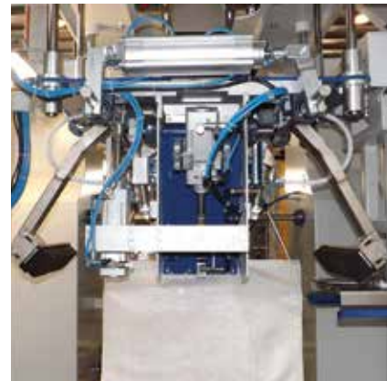
Sacköffnung für Beutelsäcke Bouche-sac pour des sacs à enveloppe
