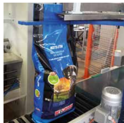
Sackführungsarme Bras de translation guide-sacs
