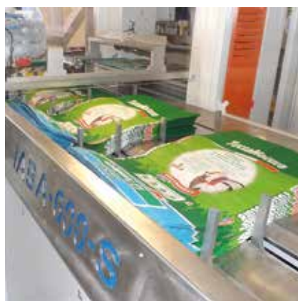
Трёхпозиционный склад мешков с вращающимся устройством отслаивания
