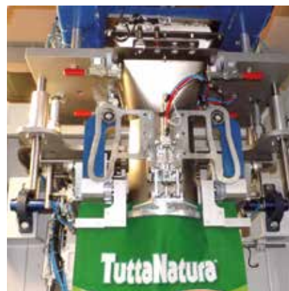
Подвесной бункер для мешков с клапанами
