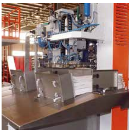
Двухпозиционный склад мешков
