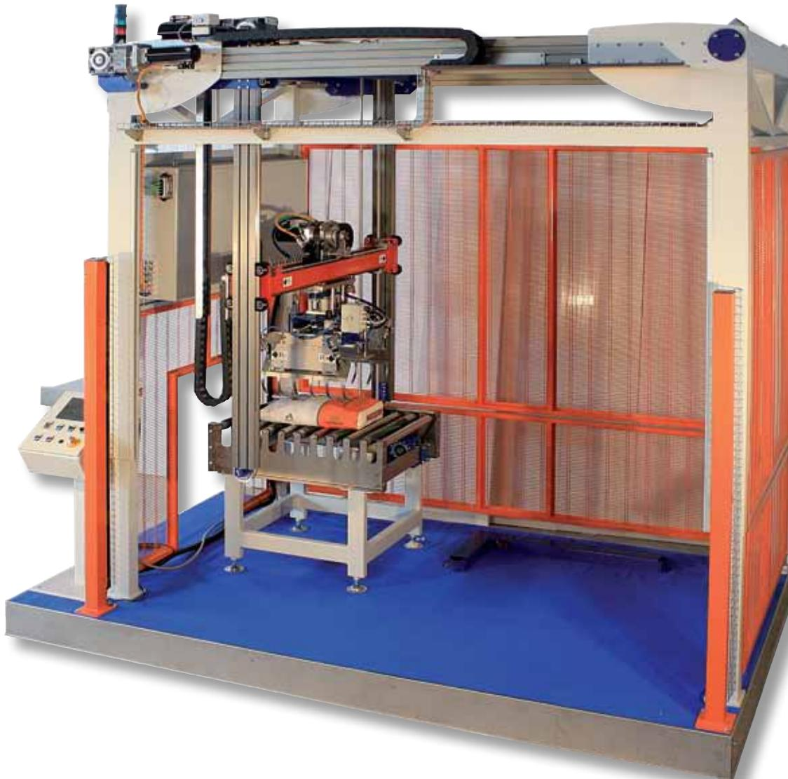
Das Portal MF-PCA-400 wurde zur Bewegung kleiner Leistung gefertigt (bis zu 400 Säcke/Stunde) und um auf effiziente Weise in relativ kleinen Räumen arbeiten zu können. Die Bewegung der X, Y, Z und R Achsen mit Interpolierungssystem der Bewegungen auf 4 Achsen reduziert die Laufzeiten.
