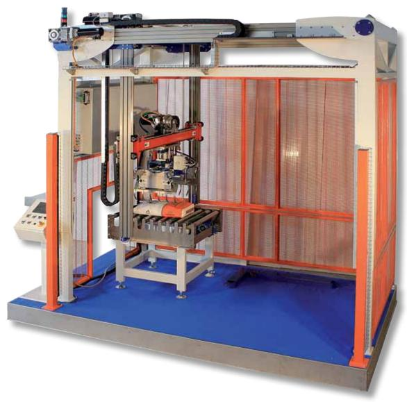
Установка MF-PCA-400 спроектирована специально для перемещения небольших объемов продукции (до 400 единиц/час) и для эффективной работы в относительно малых помещениях. Движение по осям X, Y, Z и R с системой интерполяции движения по 4 осям снижает сроки прохождения.
