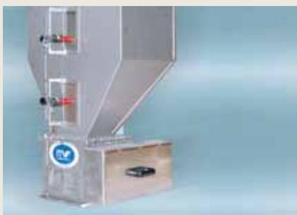
Per prodotti granulari ad ottima scorrevolezza. Dosatore costituito da una serranda "a casco" in grado di parzializzare il flusso di prodotto durante le fasi di sgrossatura, finitura e taglio finale. La serranda può essere azionata da un dispositivo elettro-pneumatico o da un motore "brushless", a seconda delle velocità che si intendono raggiungere.
