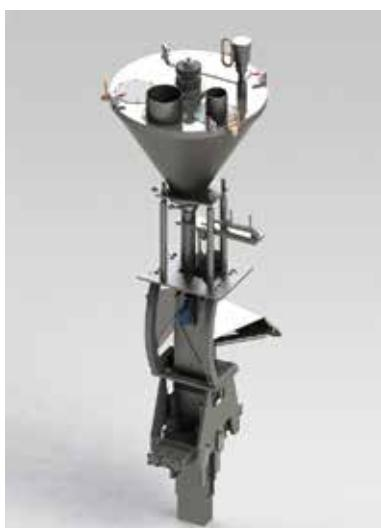
Durch die "Schnellmontagevorrichtungen" der mechanischen Kopplungen, die für die Bewegungsübertragung an die Organe des Dosierers zuständig sind, lassen sich Dosierer und Formungsrohr mithilfe eines Flaschenzugs (oder anderen Hubmittels) binnen weniger Minuten auswechseln.
