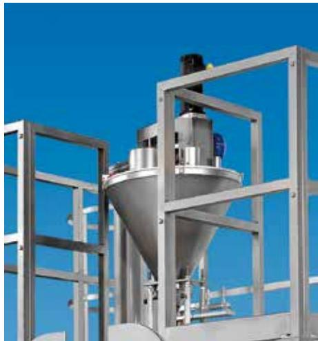
Die Verwendung von Volumendosierern ist beim Abpacken von Produkten mit hoher Fließfähigkeit erforderlich, da sie dazu neigen, beim Dosieren und Abfüllen viel Luft zu absorbieren. Um das zu vermeiden wird ein Volumendosierer mit vertikaler Förderschnecke verwendet, der das Produkt schnell und mit Präzision abfüllt, ohne dass große Luftmengen absorbiert werden können. Im Gegenteil, das Produkt wird geradezu geplättet und somit bereits beim Dosieren entsprechend kompaktiert.
