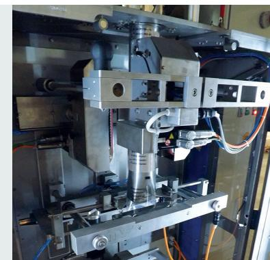
*Dispositivo de soldadura vertical contínuo com rotação controlada por servo-motor brushless, com temperatura constante controlada por PLC.*
