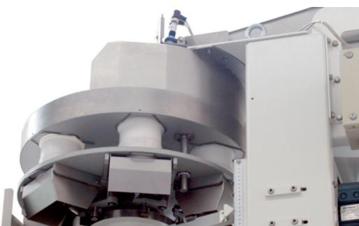
Como alternativa ao sistema de pesagem com balança multicabeça, a MF 52C pode estar equipada com dosador volumétrico rotativo tipo caçamba, simples ou duplo. Esta solução revela-se particularmente adequada para produtos granulares (sal, açúcar granulado, farinha de milho, cuscuz, cereais, leguminosas secas, frutos secos, detergentes em pó, pasta pequena, arroz, etc)
