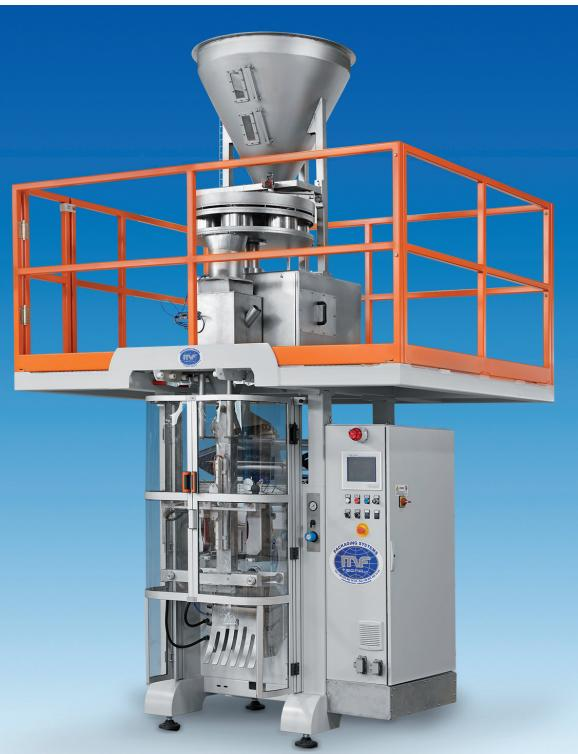
Comme alternative au système de pesage avec balance multi-têtes, la MF 52C peut être équipée avec doseur volumétrique rotatif à godets, simple ou double. Cette solution est particulièrement indiquée pour les produits granulaires (sel, sucre, farine de maïs, couscous, céréales, légumes secs, fruits secs, détergents en poudre, petites pâtes, riz, etc.).
