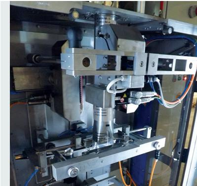
*Dispositif de thermo-soudage verticale continue avec une rotation contrôlée par servomoteur sans balais, une température constante contrôlée à travers l'API.*
