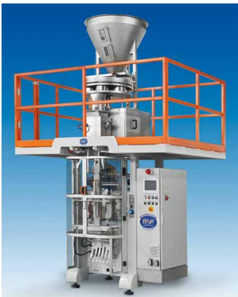
*La machine MF 52 avec Doseur Volumétrique Rotatif à Godets est une conditionneuse verticale étudiée pour des produits granulaires (sel, sucre en poudre, farine de maïs, couscous, céréales, légumes secs, fruits secs, détersifs en poudre, pâtes petites, riz, etc.).*
