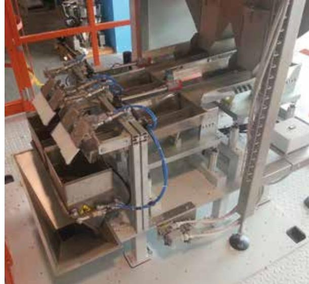
*Si l'emballage ne requiert pas de productions particulièrement élevées, des produits analogues à ceux décrits jusqu'ici peuvent être dosés avec une ou plusieurs peseuses électroniques équipées d'alimentateurs à canaux vibrants en acier inox.*
