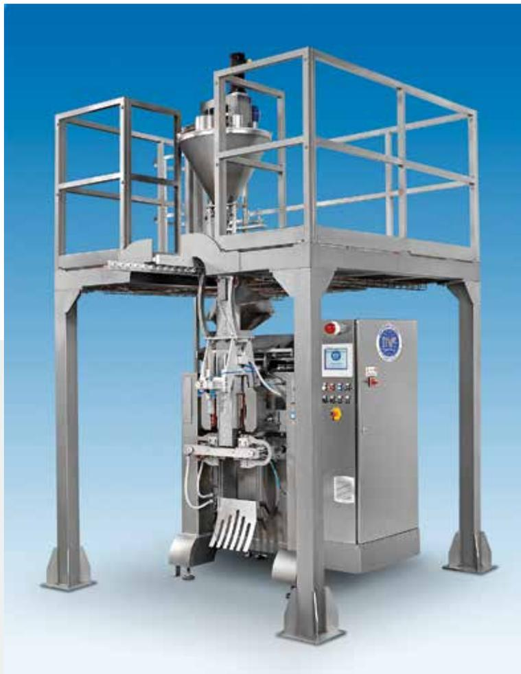
Grazie allo "sgancio rapido" degli accoppiamenti meccanici che trasmettono il moto agli organi del dosatore, con l'ausilio di un paranco installato a bordo macchina (o con altro mezzo di sollevamento) sarà possibile in pochissimi minuti sostituire il dosatore/tubo formatore.
