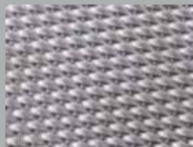
Sia per la realizzazione delle tazze delle bilance multitesta che dei canali vibranti e delle relative tramogge, esiste la possibilità per prodotti particolari (come quelli di quarta gamma) di realizzare le varie parti in contatto con lamiera di acciaio Inox bugnata.
