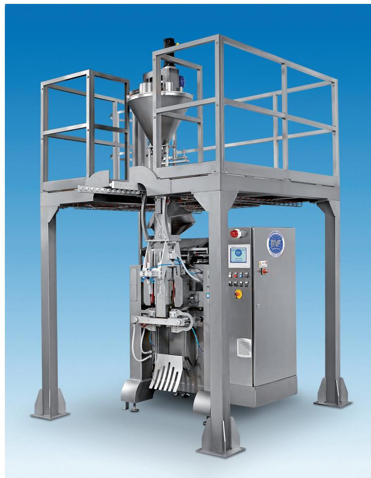
Благодаря системе "быстрого снятия" механических соединений, которые передают движение органам дозатора, с помощью лебедки, установленной на машине (или другого устройства подъема) можно будет в течение нескольких минут заменить дозатор/формующую трубу.
